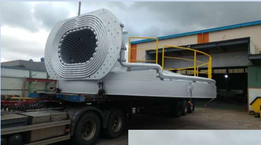
120톤 제강 전기로 SPRAY ROOF
